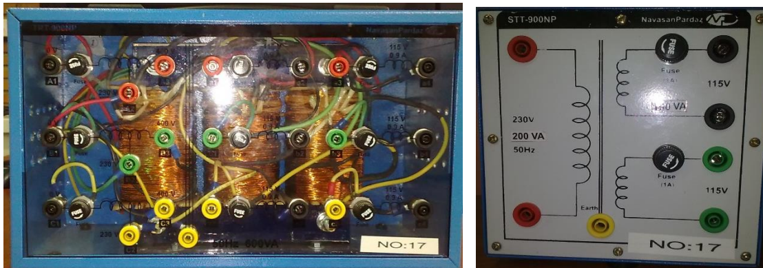
شکل ۱: نمونه ترانسفورماتورهای استفاده شده در آزمایشگاه تبدیل انرژی ۱. الف) ترانسفورماتور تکفاز. ب) ترانسفورماتور سه فاز
